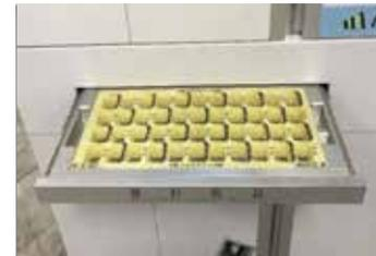
支持半片藥和异形藥手工擺放的DTA託盤，單託盤共44格。處方中有非機儲藥品時，DTA託盤自動彈出，螢幕提示DTA添加藥品資訊並自動列印補藥清單。設備內真兩個DTA託盤，可交替使用，滿足多個病人多餐集中添加，提高分包效率。
